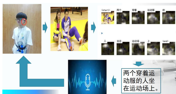
图 2 视觉辅助系统佩戴及原理
