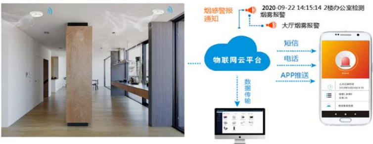
图 2 智慧烟感探测功能示意图
