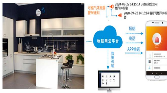
图 3 智慧可燃气体探测器功能示意图
