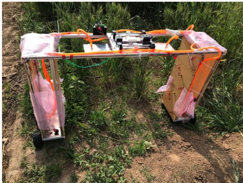
图 2 喷药机器人实验模型
