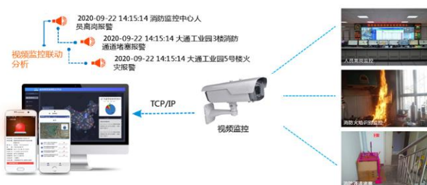
图 7 智能无线视频监控功能示意图
