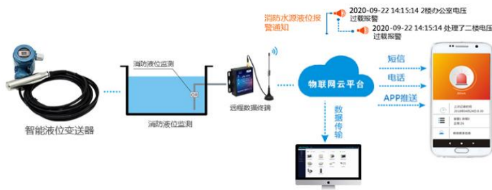
图 5 智能消防水源监测功能示意图
