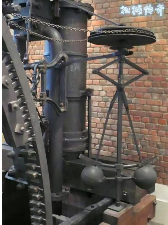
图 3 现实中的离心调速器原理
