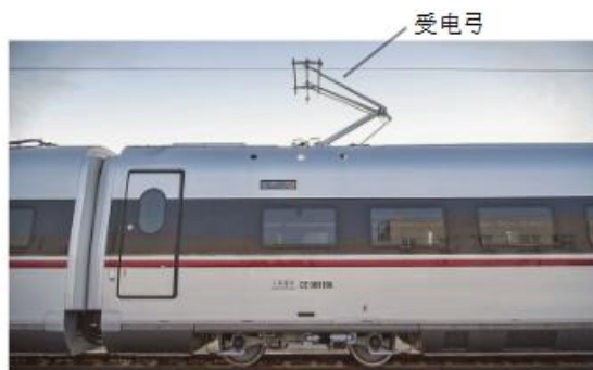
图 1 高铁上方的受电弓从接触线获取电能
