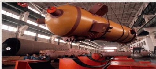
这是国家863计划重点项目10兆瓦高温汽冷试验堆的关键设备之一的蒸汽发生器1998年11月6日从上海出厂，准备运往清华大学核能技术设计研究院安装。
