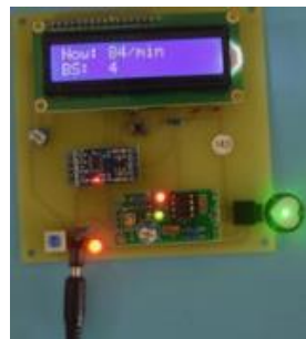
图5 用于人体心电信号检测的实用三运放电路
