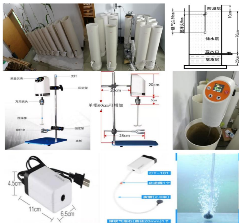
图 2 水体自净装置、实验柱示意图、智能搅拌机和曝气装置示意图
