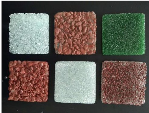
图 5 玻璃透水砖样品
