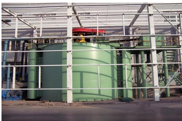
图 6 矿冶科技集团自主研发的 160 立方米浮选机
