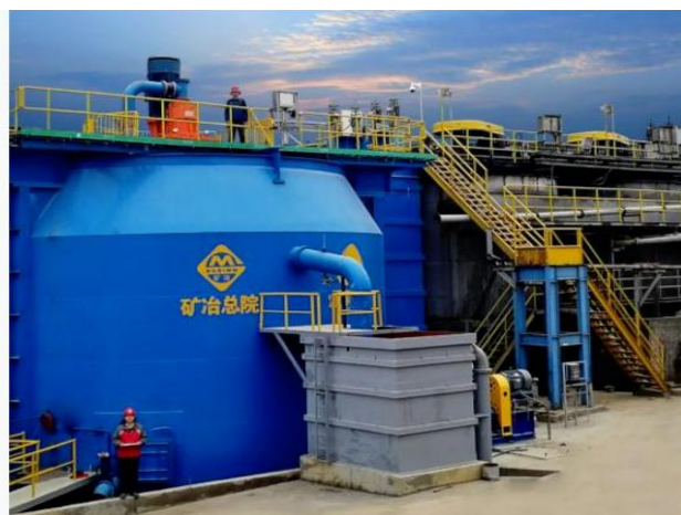
图9 矿冶科技集团自主研发的680立方米浮选机
