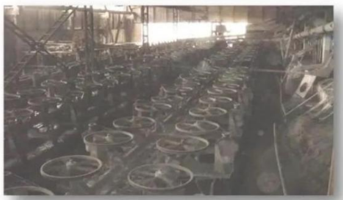
图 2 从苏联引进的 A 型浮选机
