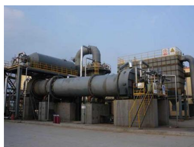
图 4 生物质干馏炉
