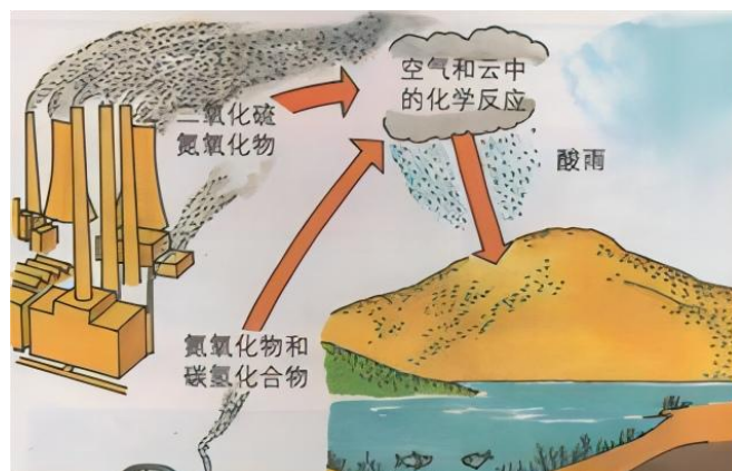
图5 焚烧废气中的酸性气体形成酸雨
