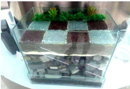
图 5 玻璃透水砖样品
