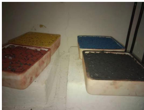
图 4 烧制中的染色透水砖
