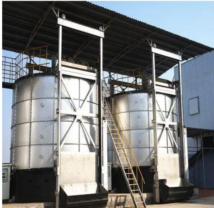
图 5 有机肥立式发酵罐
