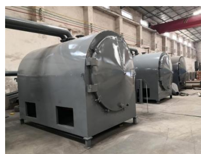
图 4 生物质干馏炉
