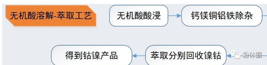
图 2 无机酸溶解-萃取回收工艺
