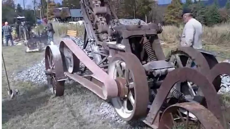
图 9 还在破碎石头的古老的颚式破碎机
