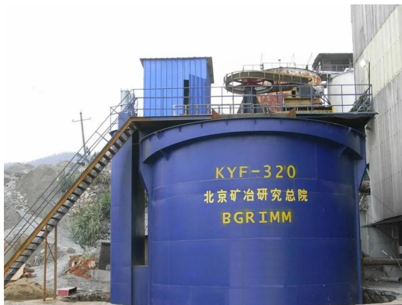
图 8 矿冶科技集团自主研发的 320 立方米浮选机
