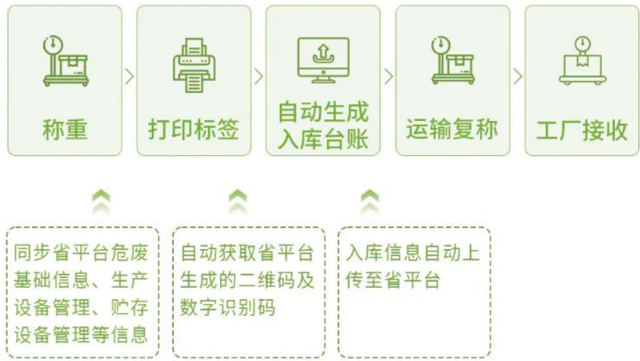
图 3 危废入库系统流程
