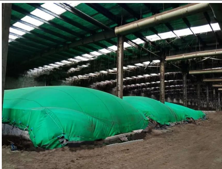
图 6 污泥生物改性膜法发酵技术
