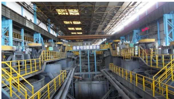
图 7 矿冶科技集团自主研发的 200 立方米浮选机
