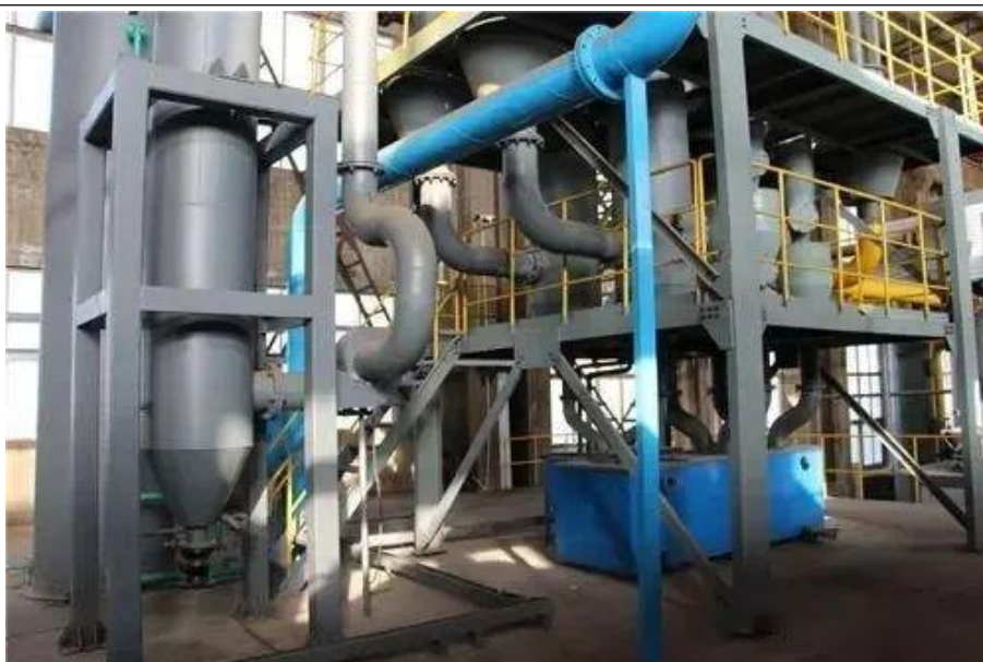
图 3 废塑料热解设备
