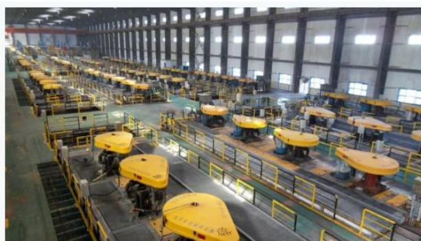
图 5 矿冶科技集团自主研发的 50 立方米浮选机
