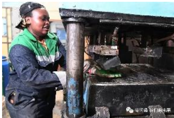
图 5 塑料砖的切割和整形
