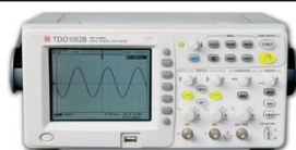
220V交流电的电压的波形显示
